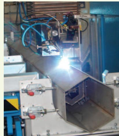
Laserové zváranie absorpcnej hexagonálnej rúry
