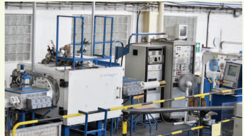
Elektrónovolúčový zvárací komplex/Electron beam welding complex
