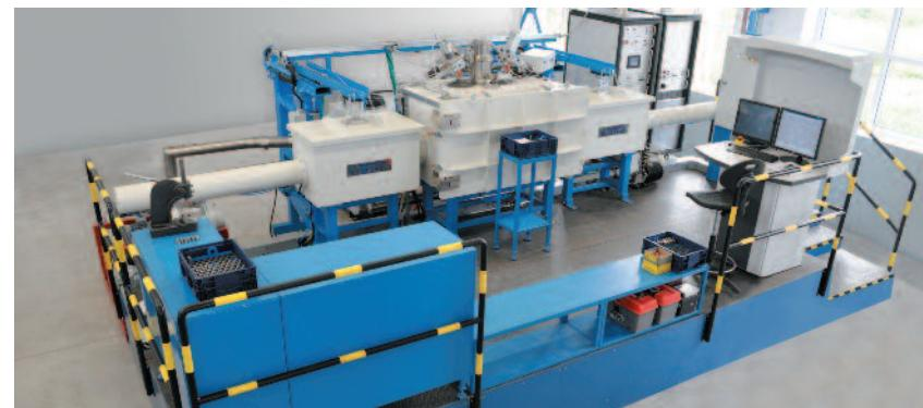
Elektrónovolúčový zvárací komplex PZ EZ ZPH/Electron beam welding complex PZ EZ ZPH
