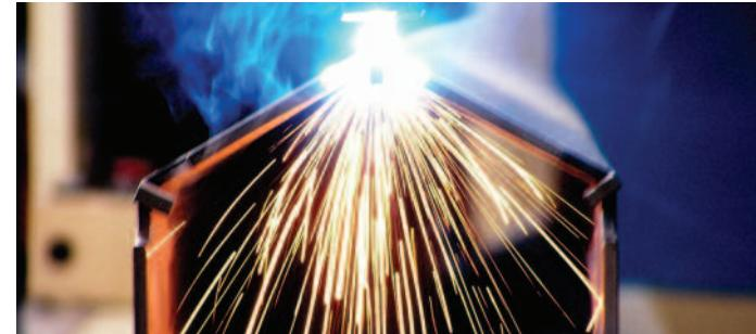
Laserové zváranie absorpčnej hexagonálnej rúry
