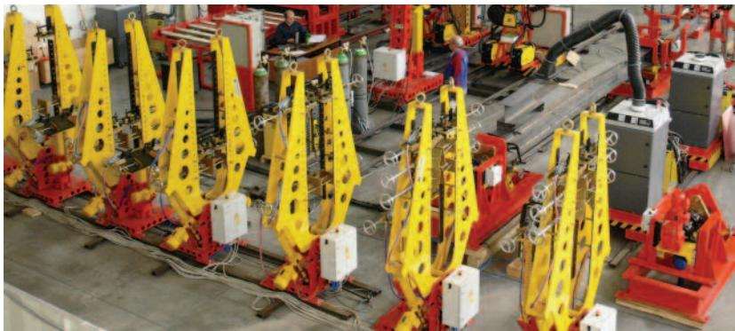
Komplex na zváranie nosníkov ľahkých priemyselných hál/Complex for welding beams of light industrial halls
