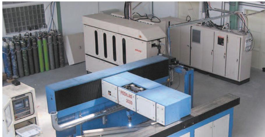
Laserový technologický komplex s CO<sub>2</sub> laserom/Laser technological complex with CO<sub>2</sub> laser
