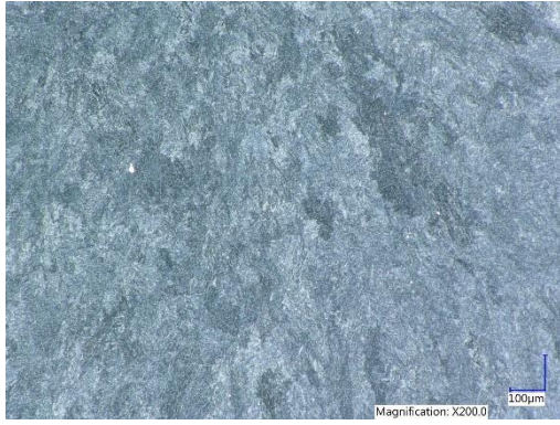
Obr.10 Mikroštruktúra návarového kovu UTP A 73 G 3
