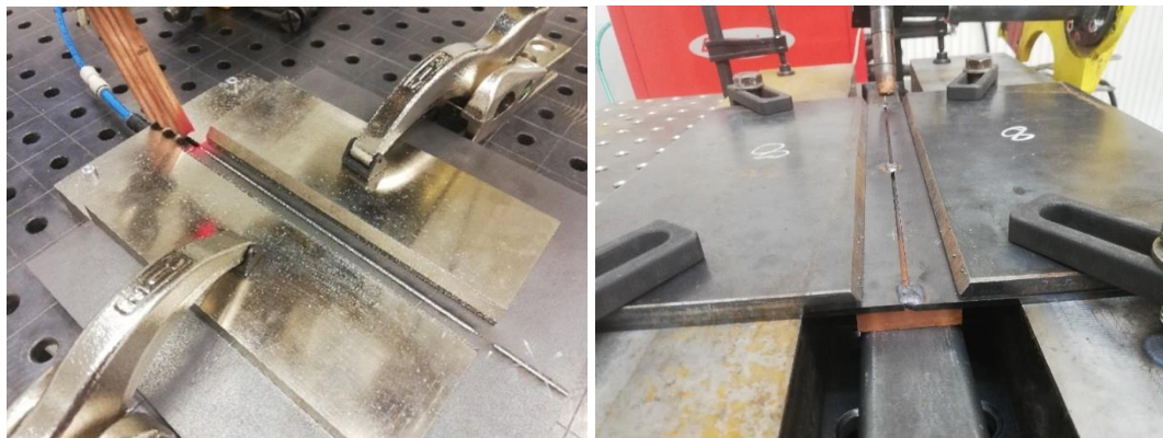
Obr. 1 Proces zvárania metódami: a) LBW; b) MCAW.
