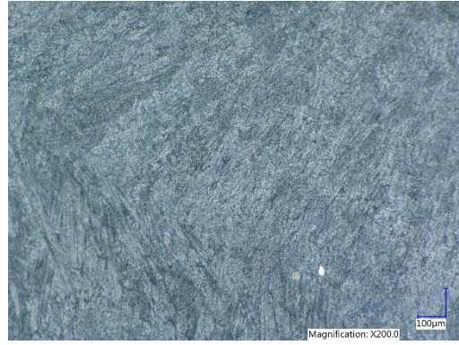
Obr.11 Mikroštruktúra návarového kovu Dievar® TIG
