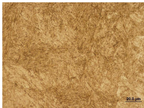
Obr.15 Mikroštruktúra návarového kovu Maraging - Dratec
